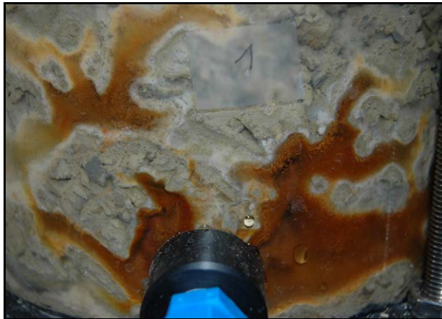
Abbildung 43: Oxidierte Eisen-Ausfällungen (rot) und Aluminiumausfällungen (weiß) am Zutritt von sauerstoffreichem sauren Wasser in Kalkstein
