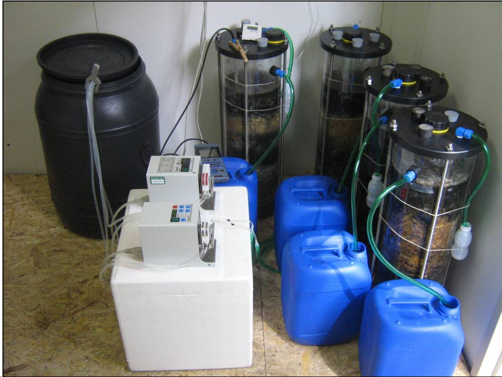
Abbildung 23: Großmaßstäbliche Säulenversuche mit Pferdemist-/Miscanthus- und Kalksteinfüllung
