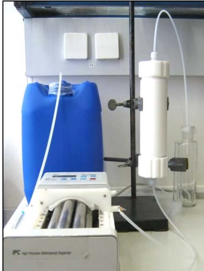
Abbildung 17: Säulenversuch zur Neutralisation des Tagebauwassers mit Kalkstein (Reußen)
