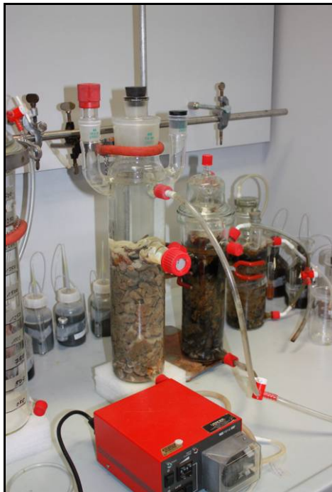
Abbildung 21: kleinmaßstäblicher Simulationsversuch mit 3 Stufen (Kalkstein, Pferdemist, Pferdemist/ Miscanthus)
