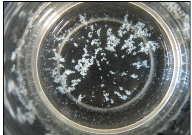
Abbildung 44: Ausfällungen nach Neutralisation in der Kalksteinsäule
