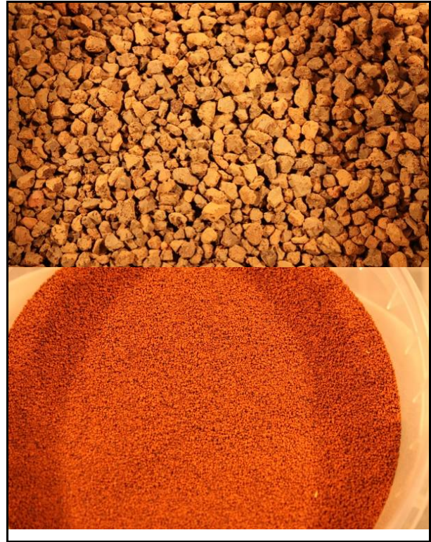
Abbildung 20: Verwendete FerroSorp® Granulate: oben: FerroSorp® Plus (2-4mm), unten: FerroSorp® DG+ (0,06-0,5 mm)
