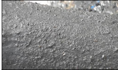
Abbildung 1: Geotextil um Drainagerohr mit Ablagerungen
